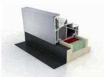
Die Außenseite wird bei diesem Profil um den Rücken des Fensterblechs + RALMO®-Komp 23/1-2 schmäler produziert (ca. 3–4 mm), somit erhält man einen flächenbündigen Anschluss. Diese Montage geht nur bei Entwässerung nach vorne.
